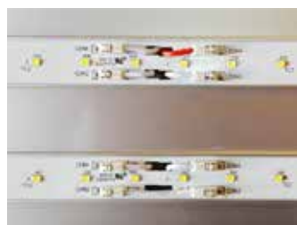
Moduli LED sostituibili
